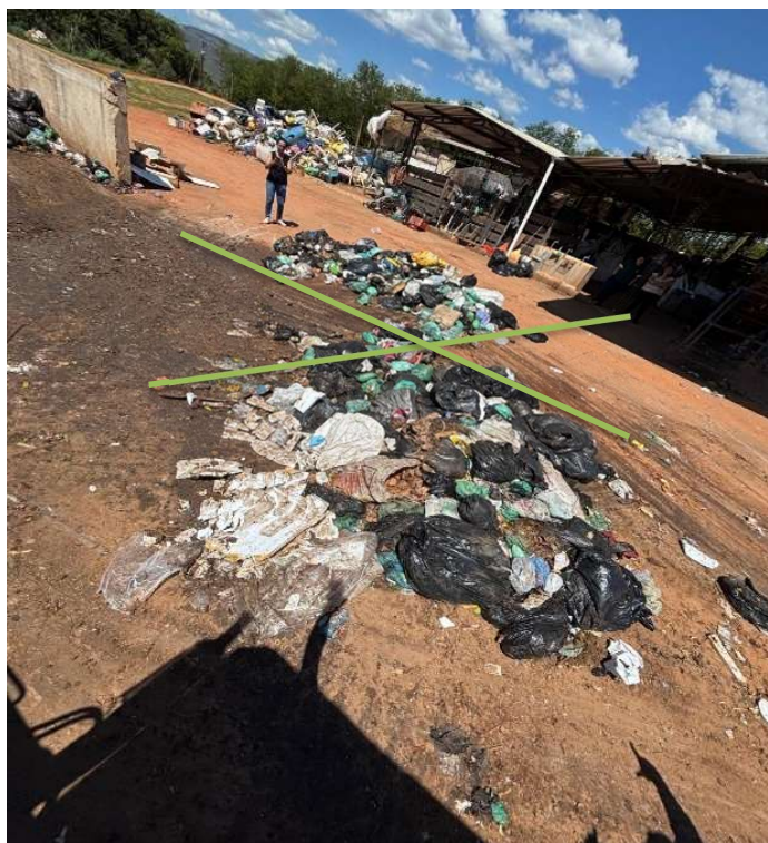
Figura 09: Processo de quarteamento da amostra.
