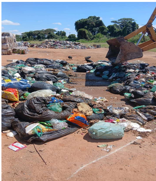
Figura 07: Processo de quarteamento da amostra.
