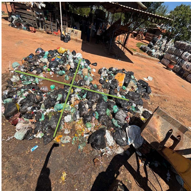
Figura 08: Processo de quarteamento da amostra.
