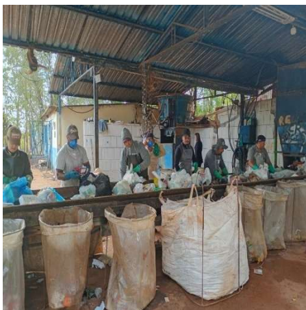
Figura 4 – Processo de triagem na esteira.
