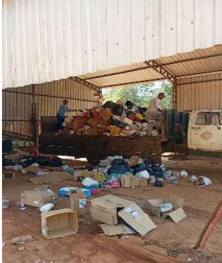
Figura 2 – Descarregamento dos resíduos na tulha de alimentação da UTC.
