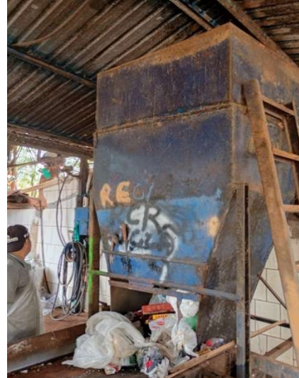
Figura 3 – Tulha alimentando a esteira de seleção.
