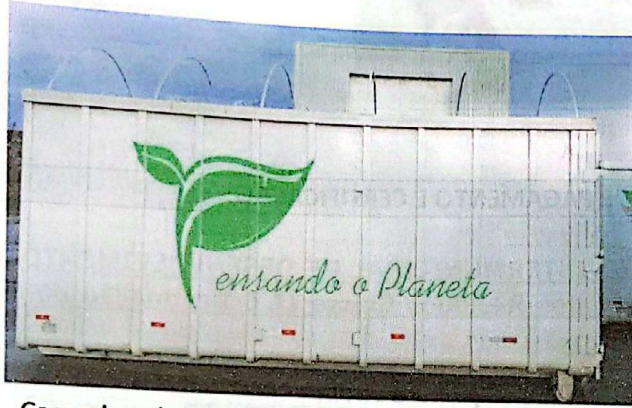
Caçambas de 36 m 3 . Medidas: 6,5 m. de compr., 2,40 m. de largura e 2,50 m. de altura.
